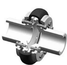
dessin 1: joint avec collier en caoutchouc
